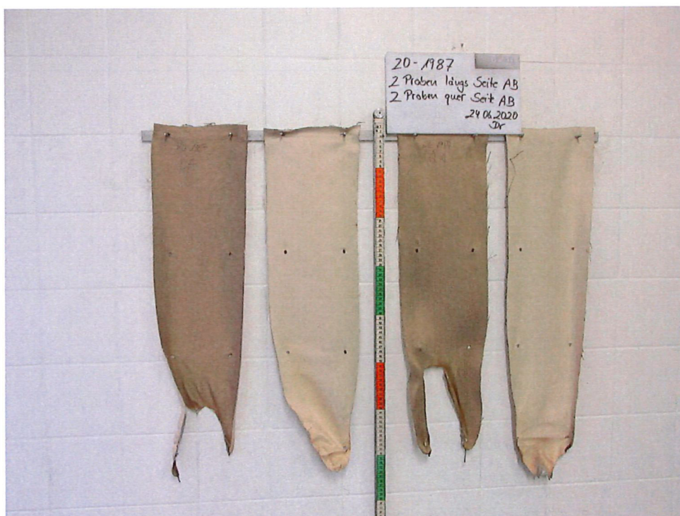
Bild 2: Aussehen der Proben nach dem Brandversuch
