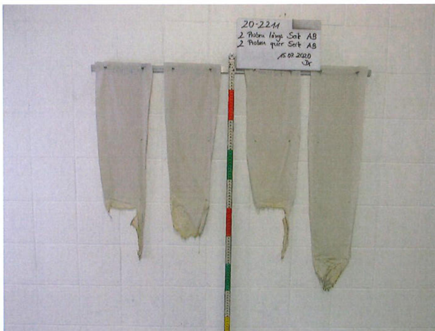
Bild 2: Aussehen der Proben nach dem Brandversuch
