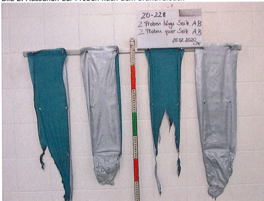
Bild 2: Aussehen der Proben nach dem Brandversuch
