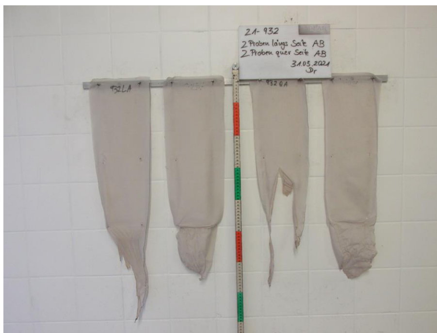
Bild 2: Aussehen der Proben nach dem Brandversuch
