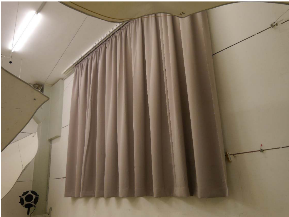
Abbildung B.2. Prüfobjekt im Hallraum: Schrägansicht.
