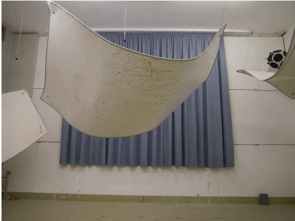
Abbildung B.1. Prüfanordnung im Hallraum (Frontalansicht).
