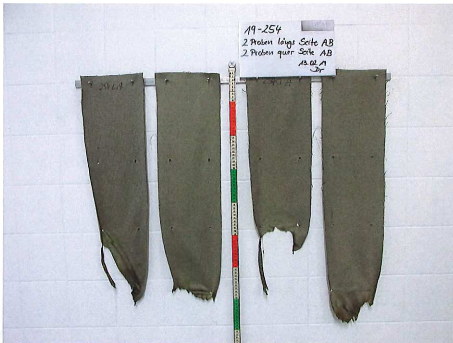
Bild 2: Aussehen der Proben nach dem Brandversuch
