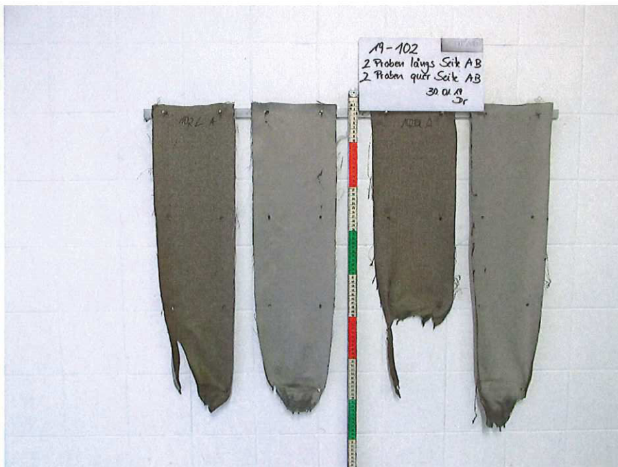
Bild 2: Aussehen der Proben nach dem Brandversuch
