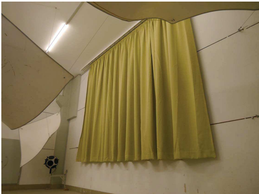
Abbildung B.2. Prüfanordnung im Hallraum (Schrägsicht).
