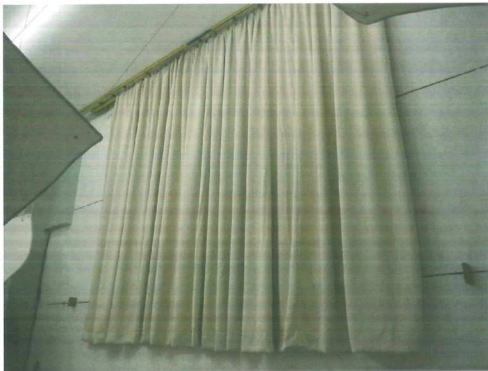
Abbildung B.2. Prüfanordnung im Hallraum (Schrägansicht)
