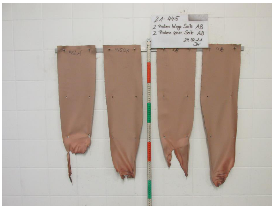
Bild 2: Aussehen der Proben nach dem Brandversuch
