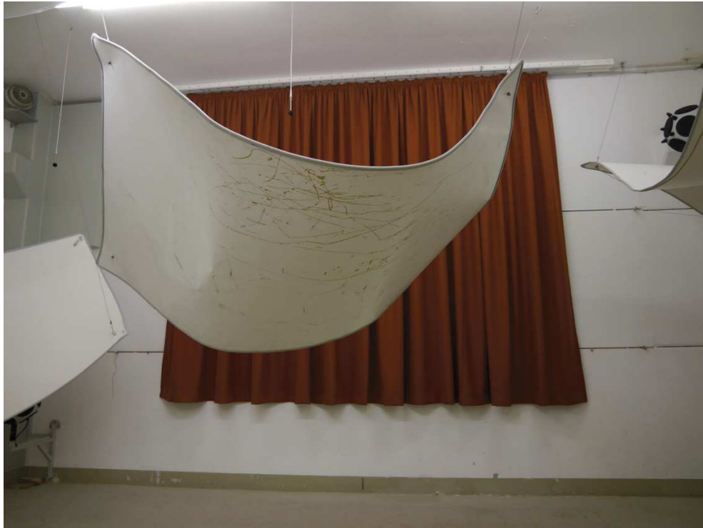
Abbildung B.1. Prüfanordnung im Hallraum (Frontalansicht).
