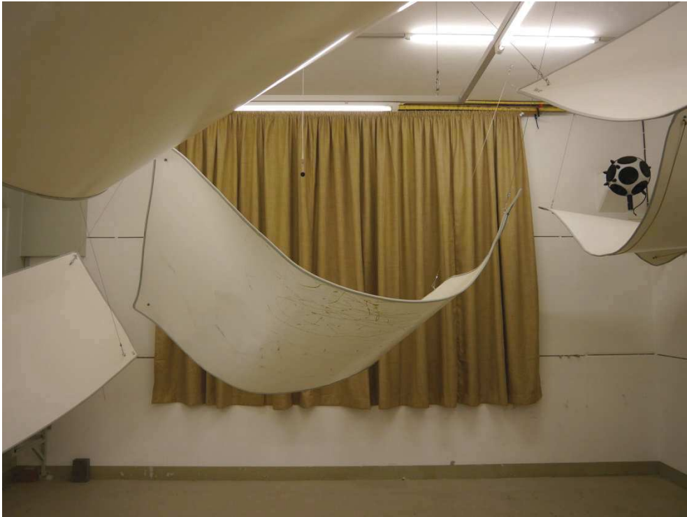
Abbildung B.1. Prüfanordnung im Hallraum (Frontalansicht).
