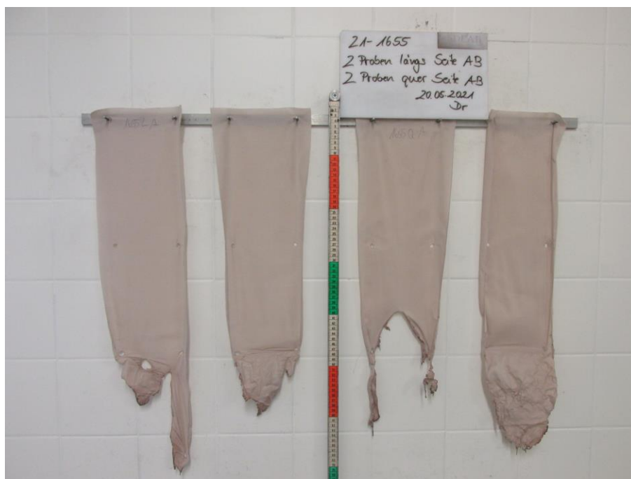
Bild 2: Aussehen der Proben nach dem Brandversuch
