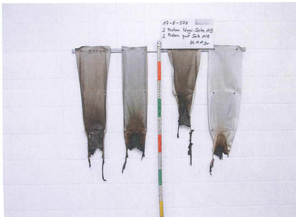
Bild 2: Aussehen der Proben nach dem Brandversuch
