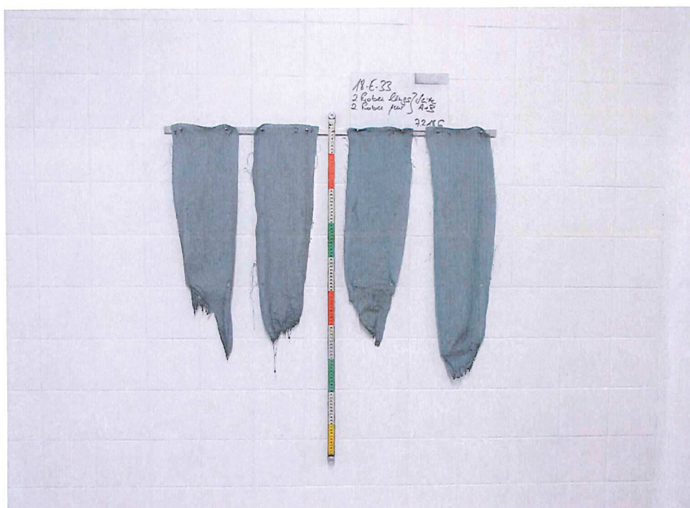
Bild 2: Aussehen der Proben nach dem Brandversuch
