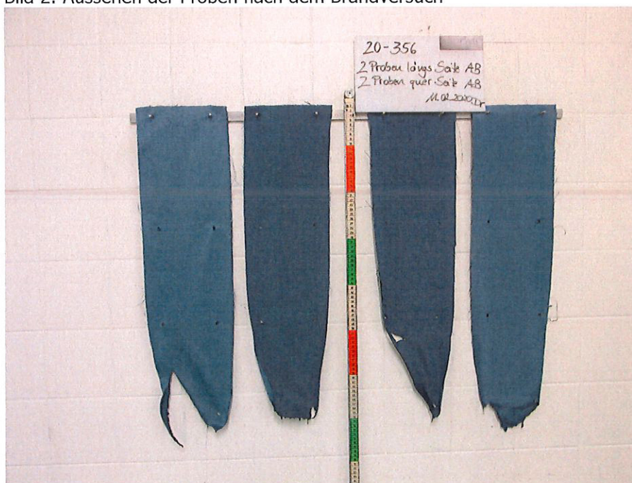
Bild 2: Aussehen der Proben nach dem Brandversuch
