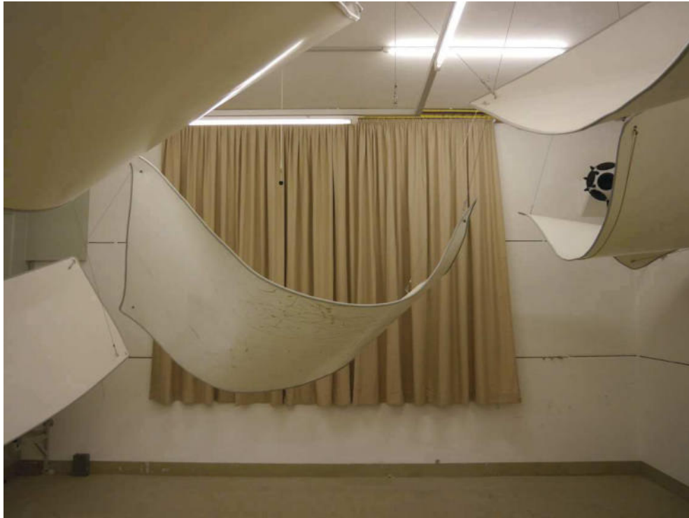
Abbildung B.1. Prüfanordnung im Hallraum (Frontalansicht).
