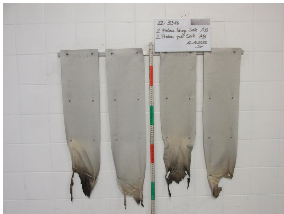
Bild 2: Aussehen der Proben nach dem Brandversuch
