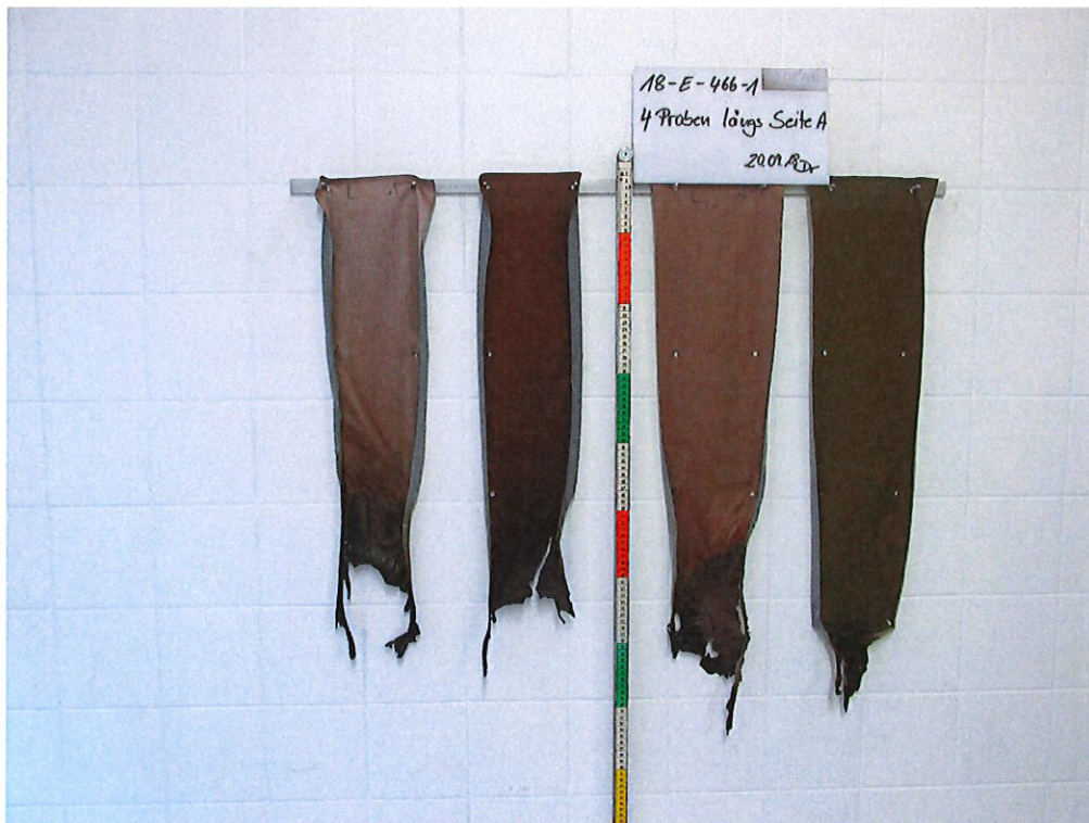
Bild 2: Aussehen der Proben nach dem Brandversuch
