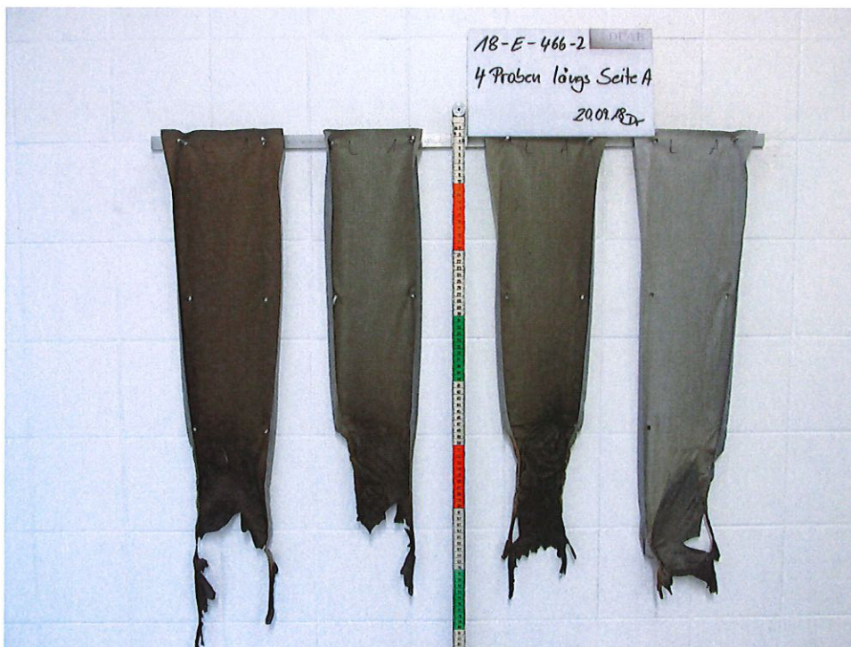
Bild 2: Aussehen der Proben nach dem Brandversuch
