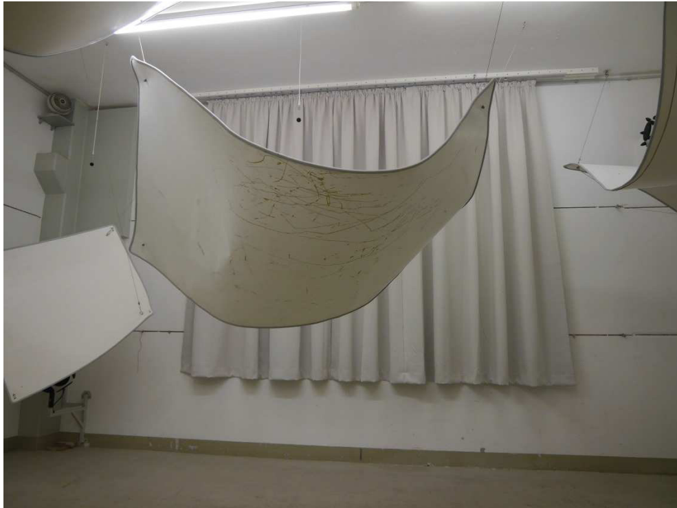
Abbildung B.1. Prüfanordnung im Hallraum (Frontalansicht).
