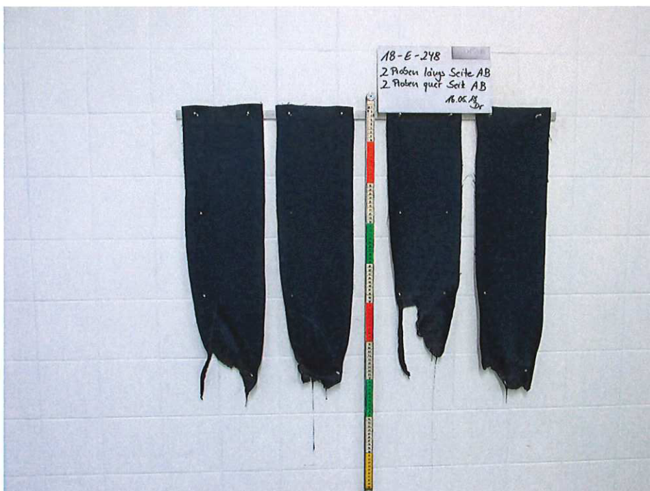
Bild 2: Aussehen der Proben nach dem Brandversuch
