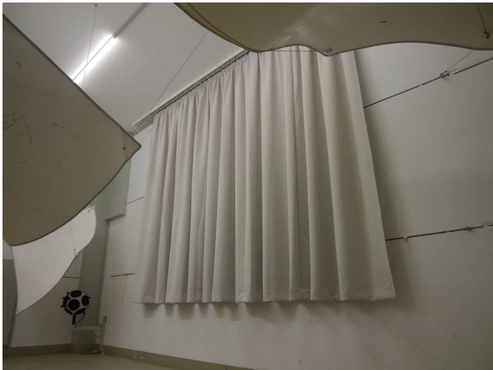
Abbildung B.2. Prüfanordnung im Hallraum (Schrägsicht).
